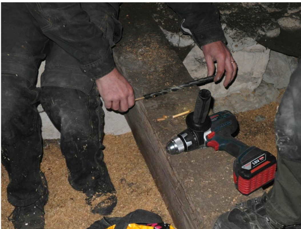
En provbit plockas försiktigt ur borren.
